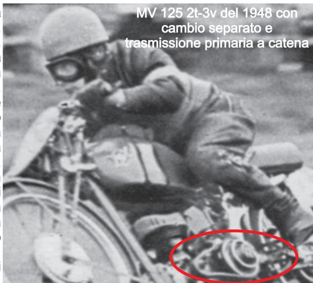
MV 125 2t-3v del 1948 con cambio separato e trasmissione primaria a catena
