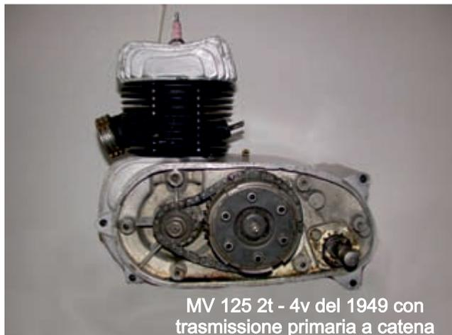
MV 125 2t - 4v del 1949 con trasmissione primaria a catena
